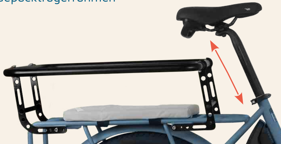
Montage der Reling an den Aufnahmen am Gepäckträgerrahmen
